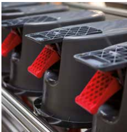
➤ V rámci testů kvality prochází šlapací modul rotačního mopu Easy Wring and Clean 75 tisíci šlapacími cykly.
